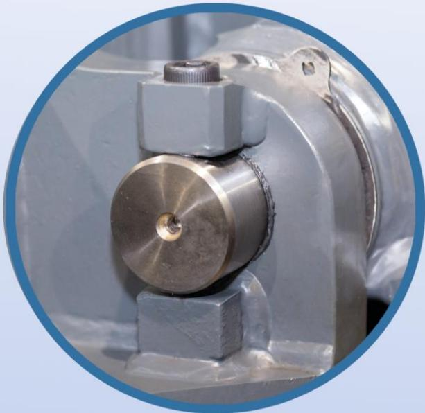
Болты крепления осей лепестков вкручиваются не в корпус грейфера, а в резьбовой упор, привариваемый к корпусу грейфера, и в случае поломки болта, может быть срезан и заменен на новый
