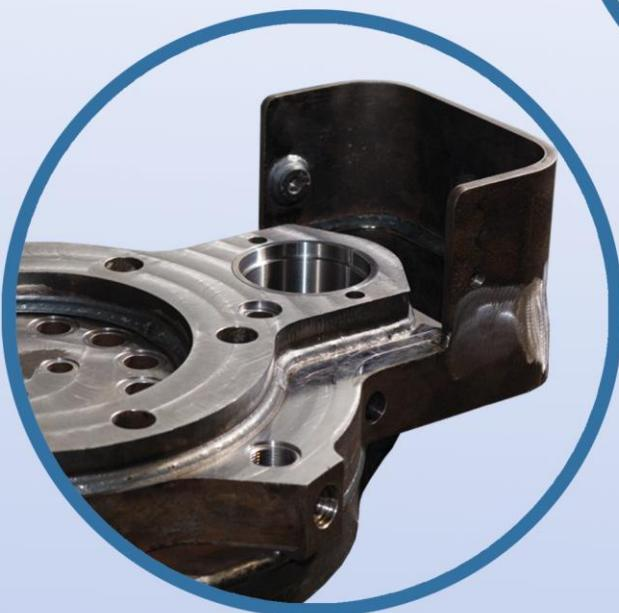
В среднем фланце в месте установки подшипников шестерни ротатора Z13 предусмотрена сменная втулка.
